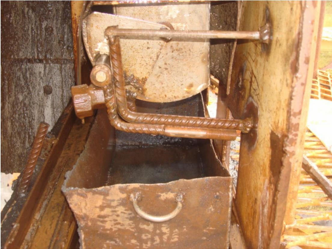
Figura 21 - Padrão de limpeza periódica do amostrador
